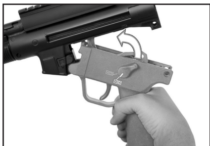
Fig. 50 – Insert pistol grip
