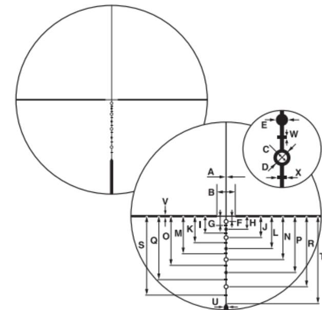
Les lettres A à X du diagramme ci-dessus désignent les différentes sous-tensions A à X du réticule indiquées dans le tableau de droite.
