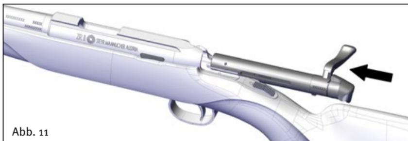
3. Halten Sie den Verschluss am Kammergriff fest und führen Sie ihn vollständig in das Gehäuse ein (Abb. 11).
